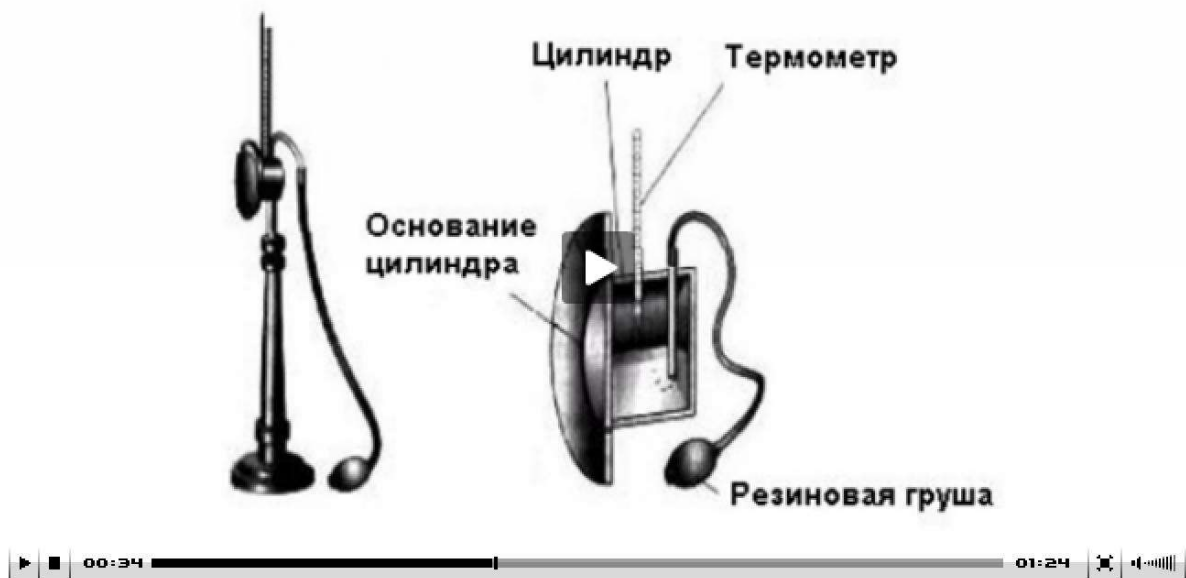
Рисунок №1. Гигрометр Ламбрехта.
